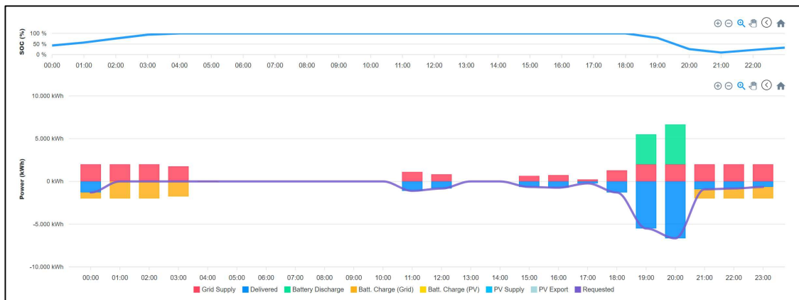
Mynd 3: Hleðslu- og afhleðsluferill rafhlöðu - Norðurleið - Sviðsmynd A
